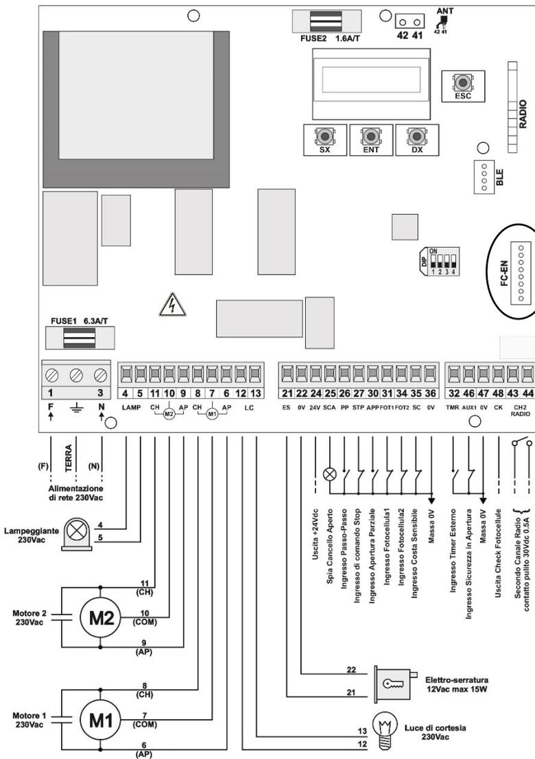
**IT** Connettore per inserire modulo finecorsa FC-EN
