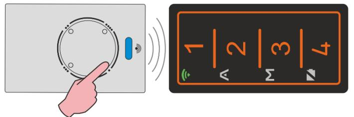
**Fase 4:** il LED **TX** inizia ad emettere un doppio lampeggio. Allontanare i due radiocomandi, premere e tenere premuti contemporaneamente per circa tre secondi i tasti **1** e **2** del radiocomando F/G, quindi rilasciarli. Il LED del radiocomando inizia a lampeggiare.
