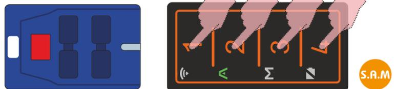
**Fase 6:** la copia è terminata, il tasto del FACILE PRO con all'interno il codice BFT necessita di essere memorizzato nella ricevente originale con la procedura S.A.M. (\*).
