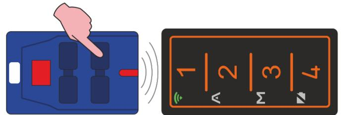
**Fase 4:** il LED **TX** inizia ad emettere un doppio lampeggio, inviare ora il codice sorgente del radiocomando BFT premendo il tasto nascosto sul retro o, nel caso di modelli più recenti, tenendo premuti contemporaneamente i tasti **1** e **2** fino a che il LED **TX** del FACILE PRO inizia a lampeggiare rapidamente, quindi rilasciarli.
