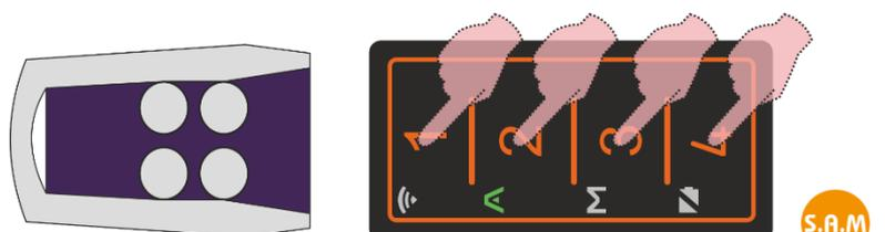
**Étape 6:** la copie est terminée, la touche du FACILE PRO avec le code V2 à l'intérieur doit être mémorisée dans le récepteur d'origine avec la procédure S.A.M. (\*).
