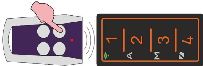
**Fase 4:** il LED TX inizia ad emettere un doppio lampeggio. Premere e tenere premuto lo stesso tasto del radiocomando V2 pressato in precedenza fino a che il LED TX del FACILE PRO inizia a lampeggiare rapidamente, quindi rilasciarlo.
