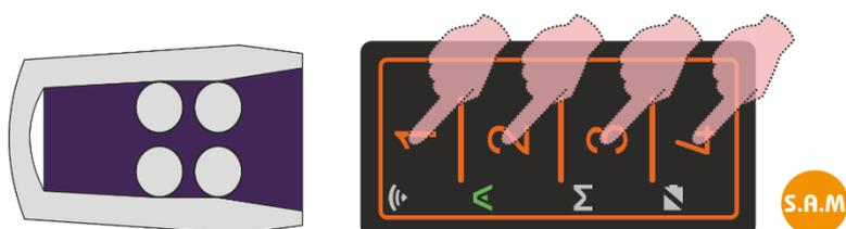
**Fase 6:** la copia è terminata, il tasto del FACILE PRO con all'interno il codice del radiocomando V2 necessita di essere memorizzato nella ricevente con la procedura S.A.M. (\*).
