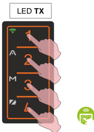
La copia è terminata, i quattro tasti del FACILE PRO con all'interno il codice del radiocomando appena copiato risultano da subito funzionanti con la ricevente originale (\*). Premere più volte i tasti del FACILE PRO per verificare il corretto funzionamento tra radiocomando e ricevente originale.
