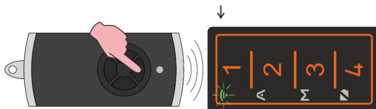
**Fase 4:** il LED del radiocomando HÖRMANN inizia a lampeggiare blu e rosso in modo alternato. Continuare a tenere premuto il tasto fino a che il LED TX del FACILE PRO inizia a lampeggiare rapidamente, quindi rilasciarlo.
