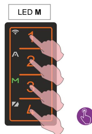
La copie est terminée, les quatre touches du FACILE PRO avec le code de la télécommande nouvellement copié doit être mémorisée manuellement dans le récepteur d'origine. Consultez le paragraphe "PROGRAMMATION DU RÉCEPTEUR" pour mémoriser les touches du FACILE PRO dans le récepteur original.
