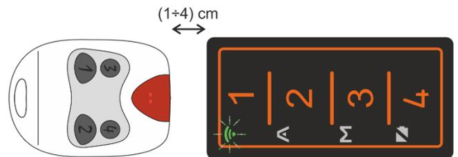
**Fase 3:** premere e tenere premuto il tasto del radiocomando a codice fisso fino a che il LED **TX** del FACILE PRO inizia a lampeggiare rapidamente, quindi rilasciarlo.
