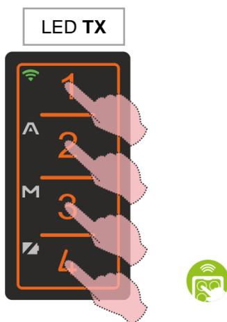
La copie est terminée, les quatre touches du FACILE PRO avec le code de la télécommande nouvellement copié est immédiatement fonctionnelle avec le récepteur original (\*). Appuyez plusieurs fois sur les touches du FACILE PRO pour vérifier le bon fonctionnement entre la télécommande et le récepteur d'origine.
