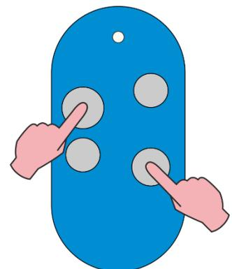
Il radiocomando CAME è impostato per trasmettere a 433,92 MHz. Rilasciare ora entrambi i tasti.
