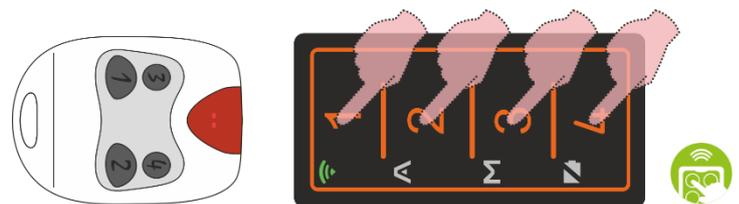
**Fase 5:** la copia è terminata, il tasto del FACILE PRO con all'interno il codice del radiocomando appena copiato risulta da subito funzionante con la ricevente originale (\*). Premere più volte il tasto del FACILE PRO per verificare il corretto funzionamento tra radiocomando e ricevente originale.
