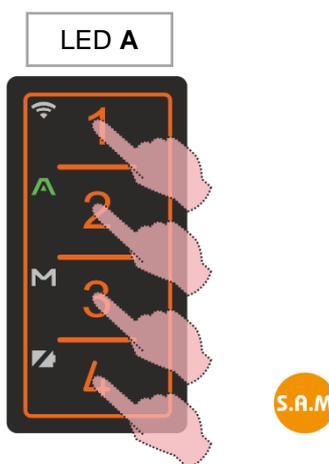
La copie est terminée, les quatre touches du FACILE PRO avec le code de la télécommande nouvellement copié doit être mémorisée dans le récepteur d'origine par la procédure S.A.M. (\*). Consultez le paragraphe "AUTO-MÉMORISATION S.A.M." pour mémoriser les touches du FACILE PRO dans le récepteur original.
