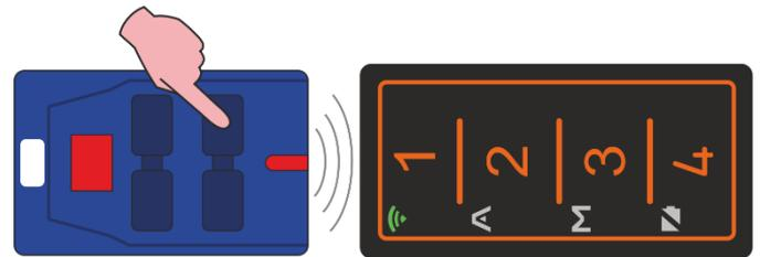
**Étape 4:** la LED **TX** commence à clignoter deux fois, envoyez maintenant le code source de la télécommande BFT en appuyant sur la touche cachée au dos ou, dans le cas des modèles plus récents, en maintenant les touches **1** et **2** enfoncées simultanément jusqu'à ce que la LED **TX** du FACILE PRO commence à clignoter rapidement, puis relâchez-les.
