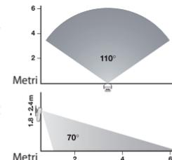
Non posizionare il sensore alla luce diretta del sole o sopra una fonte di calore.
