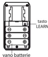
L'allarme ha un indicatore luminoso per le batterie scariche. Quando le batterie devono essere cambiate l'indicatore lampeggerà lentamente. La durata media delle batterie per un normale utilizzo è di circa un anno.
