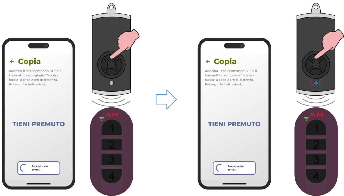
5. Il LED del radiocomando HÖRMANN si spegne. Continuare a premere il tasto del radiocomando.
