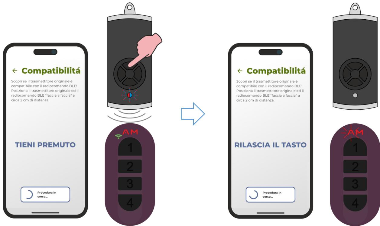
5. Il LED del radiocomando HÖRMANN inizia a lampeggiare blu e rosso in modo alternato. Continuare a premere il tasto del radiocomando.
