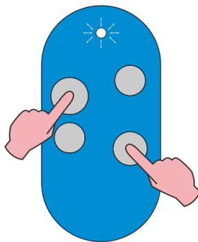
Il radiocomando CAME è impostato per trasmettere a doppia frequenza 433,92/868,35 MHz. Rilasciare ora entrambi i tasti.
