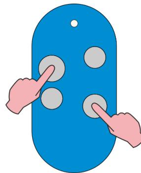
Il radiocomando CAME è impostato per trasmettere a 433,92 MHz. Rilasciare ora entrambi i tasti.
