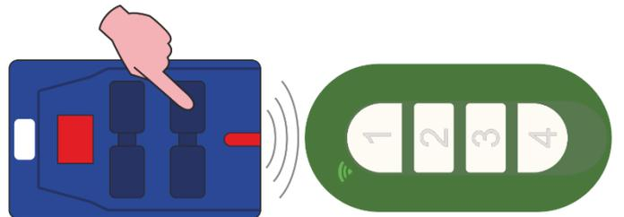
**Étape 4:** la LED **TX** commence à clignoter deux fois, envoyez maintenant le code source de la télécommande BFT en appuyant sur la touche cachée au dos ou, dans le cas des modèles plus récents, en maintenant les touches **1** et **2** enfoncées simultanément jusqu'à ce que la LED **TX** de l'AVATAR commence à clignoter rapidement, puis relâchez-les.
