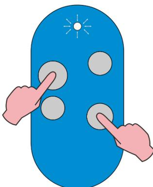
La télécommande CAME est réglée pour émettre en double fréquence 433,92/868,35 MHz. Relâchez maintenant les deux boutons.
