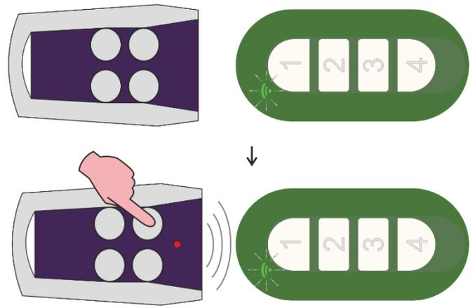
**Fase 4:** il LED **TX** inizia ad emettere un doppio lampeggio. Premere e tenere premuto lo stesso tasto del radiocomando V2 pressato in precedenza fino a che il LED **TX** dell'AVATAR inizia a lampeggiare rapidamente, quindi rilasciarlo.
