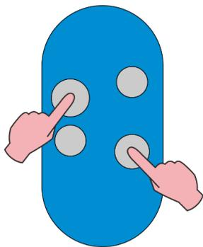
Il radiocomando CAME è impostato per trasmettere a 868,35 MHz. Rilasciare ora entrambi i tasti.
